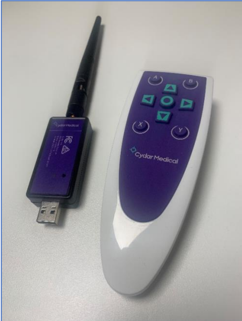
Figura: Un mando a distancia Cydar (derecha) y un receptor.
