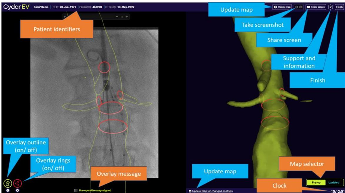
**Abbildung:** Standardlayout der Informationen und Kontrollen mit Kurzbefehlen für die Fernbedienung
