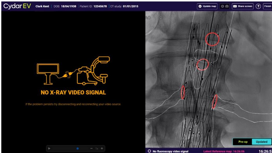
**Abbildung:** Die Nachricht am linken Rand besagt, dass die Cydar Appliance kein Videosignal vom Röntgengerät empfängt. Prüfen Sie, ob das Röntgengerät eingeschaltet ist, das DVI Kabel eingesteckt ist und alle Signalumwandler eingeschaltet sind. Fall das Problem weiterhin besteht, kontaktieren Sie bitte Cydar Online Support.
