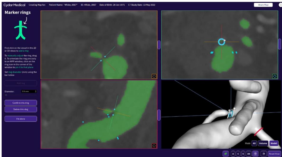
**Abbildung:** Manuelle Veränderung von Markierungsringen. Der Ring wurde im oberen rechten MPR Feld mit grünem Rand befestigt. Der blaue Ring kann in dieser Ebene verschoben werden. Wenn in den anderen MPR Feldern am Fadenkreuz gezogen wird, ändert sich die Orientierung. Die Kontrollen für die Ringdurchmesser befinden sich an der linken Seitenleiste.
